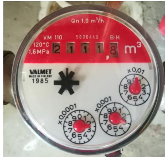
Esimerkki 2: Mittarin rullalaskurissa näkyy täysien kuutioiden (mustalla) lisäksi yksi desimaali (punaisella), jota ei ilmoiteta. Ilmoitettava lukema on 2111.
