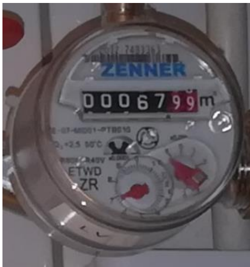
Esimerkki 3: Mittarin rullalaskurissa näkyy täysien kuutioiden (mustalla) lisäksi kaksi desimaalia (punaisella), joita ei ilmoiteta. Ilmoitettava lukema on 67.
