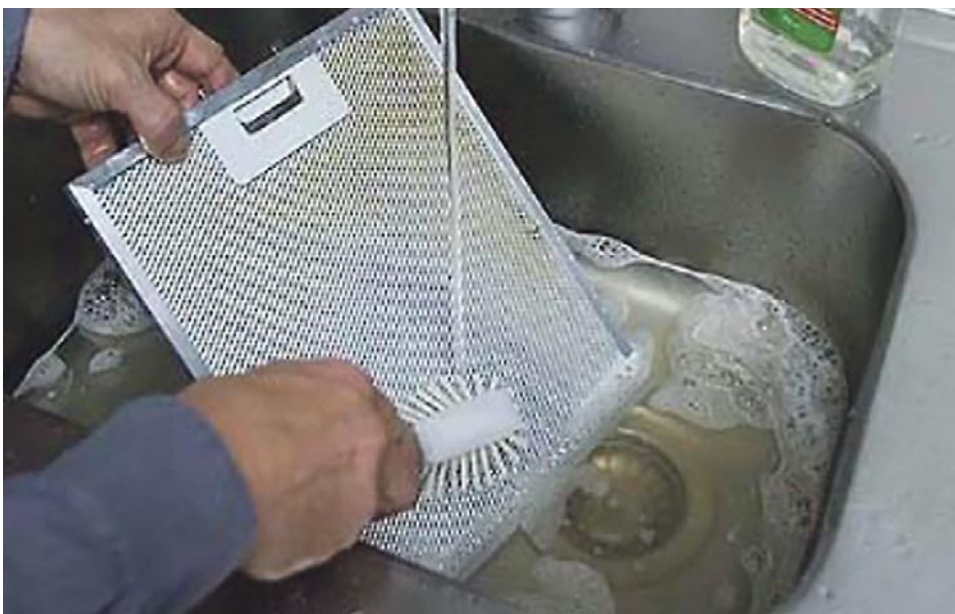
2. Metallinen rasvasuodatin pestään astianpesuaineella ja lämpimällä vedellä.
